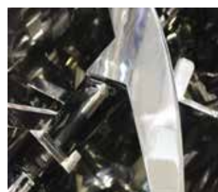
Полировка внутренней поверхности смесителей из нержавеющей стали AISI304/AISI316
